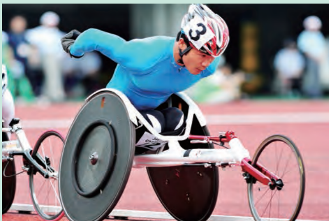
競技専用車いすは正座の姿勢でシートに乗り、前方にあるレバーを操作してカーブを曲がります
