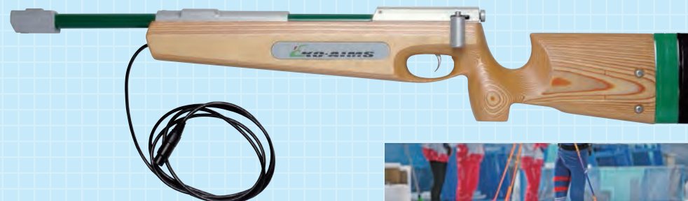
視覚障がいで使用されるビームライフルは、銃口が10m先にある直径21mmのターゲットに向かった時、1700Hz程度の高い音がヘッドフォンから流れるようになっています。
